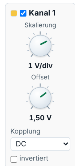
Bild 5 – Der Kasten von Kanal 1. Unter jedem Knopf steht der eingestellte Wert.
